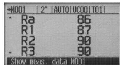
图 1 测量一般显色指数  $R_a$  和特殊显色指数  $R_1 \sim R_{15}$
